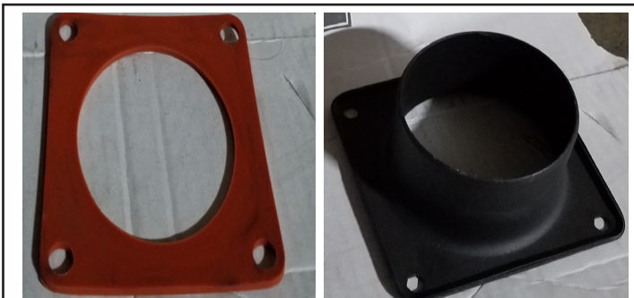
Figure 4: Adaptateur de canalisation d'air chaud
